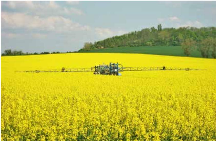
Um die Durchfahrverluste im blühenden Bestand gering zu halten, sollte die Fahrgeschwindigkeit 4 bis 6 km/h nicht überschreiten, und die Arbeitsbreite sollte möglichst groß sein. Eine Plane unter dem Schlepper kann Beschädigungen an den Pflanzen verringern. Foto: landpixel
