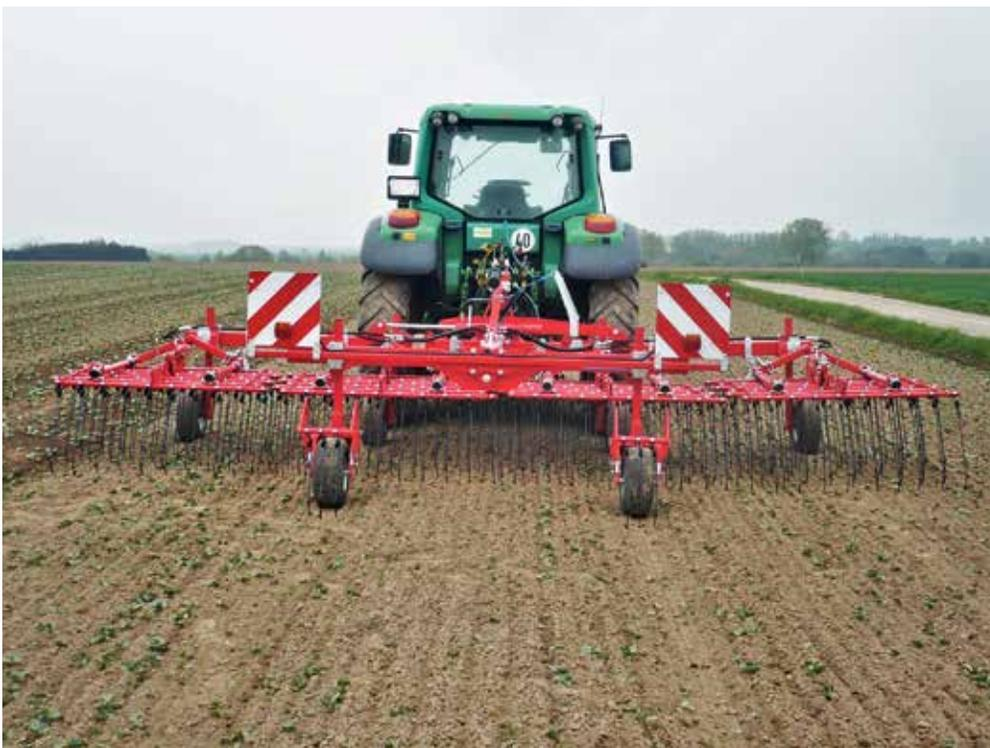
In Ackerbohnen beispielsweise kann der Striegel nach dem Auflaufen schon wieder vorsichtig eingesetzt werden – wie hier der Einböck-Exactstriegel Aerostar. Einböck regelt die Eingriffstiefe des Gerätes über adjustierbare Stützräder vorne und hinten.
