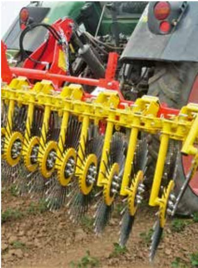
*Auch Rollstriegel (hier von APV) arbeiten reihenunabhängig auf der gesamten Fläche. Durch die Rotation wird weniger organisches Material verschleppt, und Bodenverkrustungen können besser aufgebrochen werden.*
