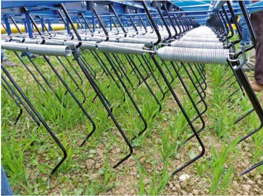
*Je nach Einsatzbedingungen müssen Zinkenstellung, Druck und Fahrgeschwindigkeit angepasst werden. Der größere Bekämpfungserfolg des Striegels liegt nicht im Herausreißen, sondern im Verschütten der Unkräuter.*
