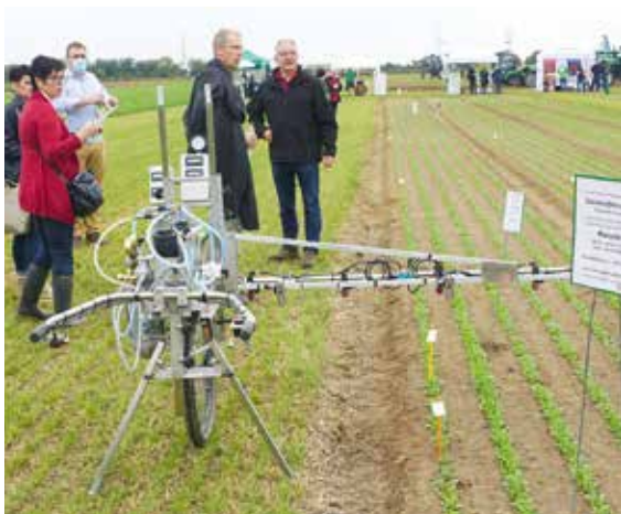
Dr. Norbert Laun erklärte Besuchern die logarithmische Spritze, die für Versuche fünffache Aufwandmengen stets mit Wasser mischt bis zur Konzentration von Null.
