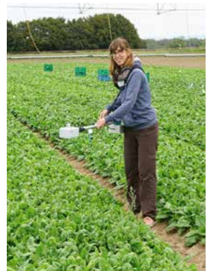
Das Spektrometer zeigt auf, ob die Pflanze, hier Spinat, unter Stickstoffmangel leidet. Auch die Wasserversorgung kann so quantifiziert werden und beides zusammen ermöglicht eine Empfehlung für den Anbauer. Foto: Setzepfand
