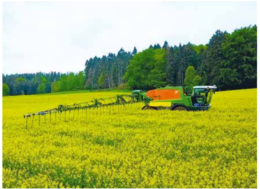
30-m-Spritze mit Dropleg-Düsen der Raiffeisen Waldeck-Marsberg.
