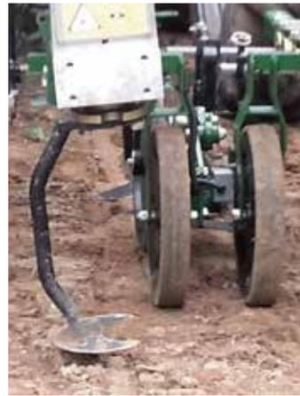
*Bei einer im Gemüsebau verbreiteten Form des Hackens ist das Hackaggregat an einem exzentrischen Antrieb angebracht.*
