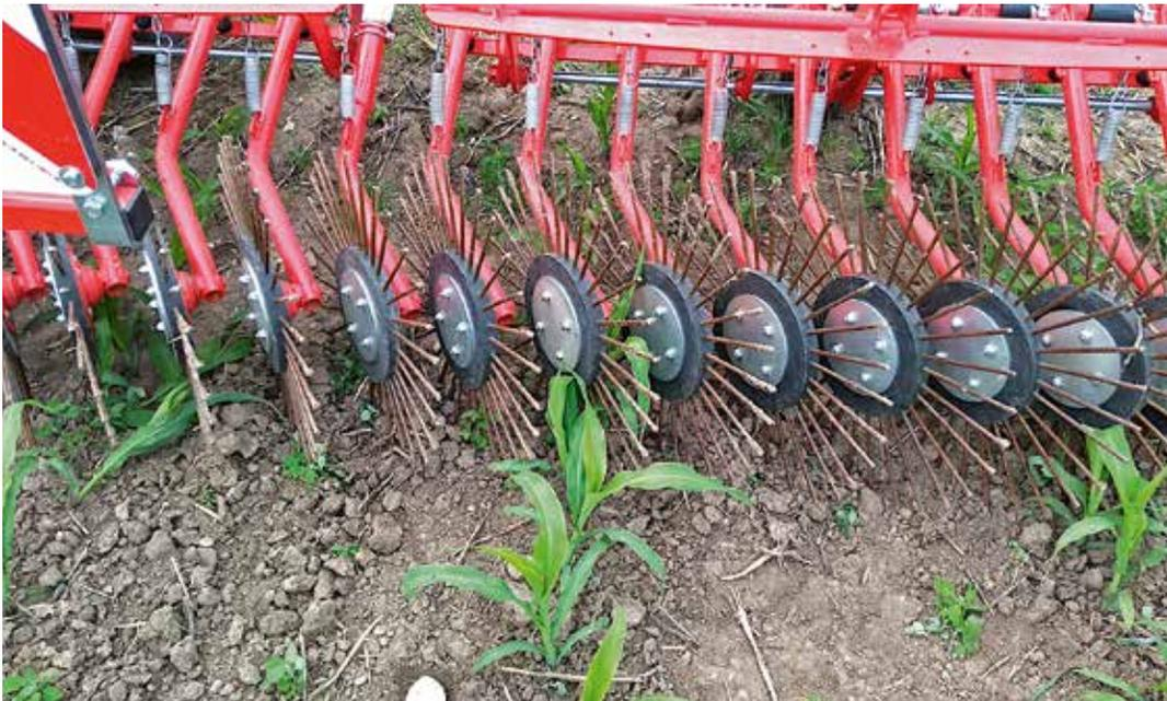
Der Rollstriegel soll Wurzelunkräuter beseitigen und Verkrustungen aufbrechen. Durch die schräge Anordnung der Räder, die durch einen Federzug noch aggressiver eingestellt werden können, kann ein optimales Arbeitsergebnis erreicht werden – beispielsweise im Maisanbau.
