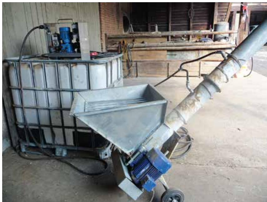
Auch für kleinere Getreidemengen geeignet: mit Hilfe eines Dosiergerätes wird das einzulagernde Futtergetreide über eine Schnecke mit Propionsäure konserviert.
