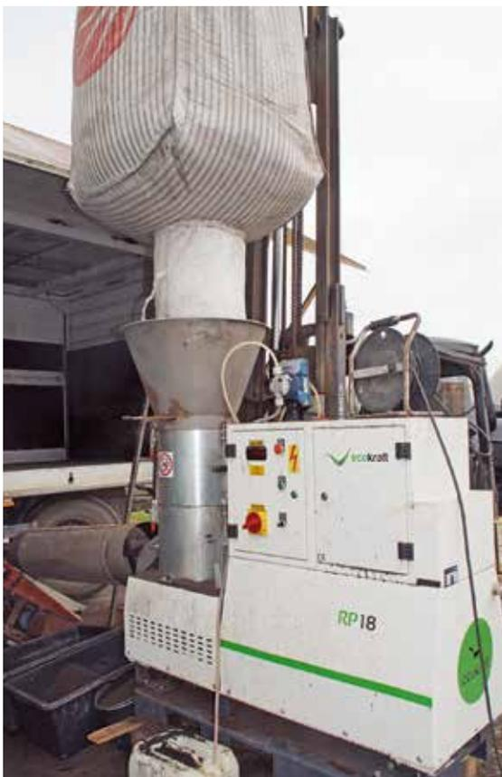
*Die Düngepellets werden in der hofeigenen Pelletieranlage aus dem getrockneten Gärrest hergestellt.*
