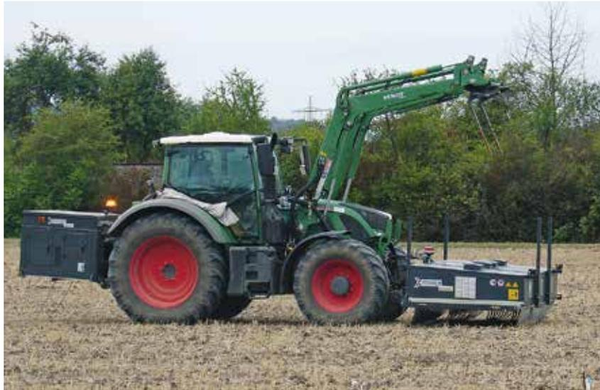
Das Electroherb-Verfahren der Firma Zasso beruht auf der Applikation von Strom durch Elektroden, die in der Front des Traktors angebaut sind. Der Strom wird von einer Generatoreinheit im Heckanbau erzeugt. Fotos: Klauk
