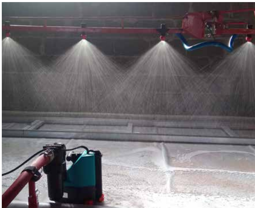
Überprüfung auf gleichmäßige Verteilung der Spritzbrühe durch die Düsen. Fotos: Feger
