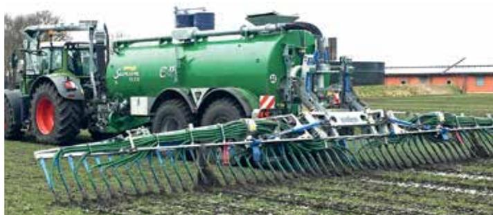
*Hier ist die NIR-Einheit mittig am Verteilrohr des Güllewagens verbaut.*
