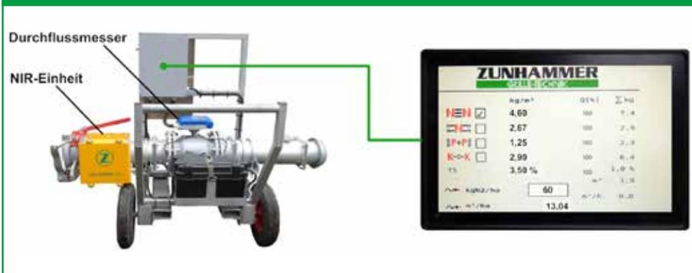
Eine mobile NIRS-Station kann beim Befüllen eines Güllefasses zur Nährstoffmessung „zwischen geschaltet“ werden. Sie besteht im Wesentlichen aus der Nahinfrarort-Einheit (NIR-Einheit), dem Durchflussmengenmesser sowie dem Bedienterminal. Sobald Gülle gefördert wird, werden die Gehalte an Stickstoff, Ammonium, Phosphor, Kali und Trockensubstanz ermittelt und über das Terminal ausgegeben.
