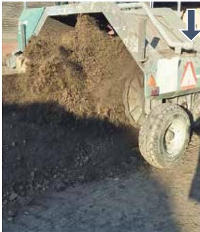
Foto 2: Kompostwender mit Anschlussmöglichkeit an die Wasserversorgung für trapezförmige Komposthaufen (Pfeil).
