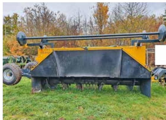
Foto 1: Kompostwender für breite Kompostmieten ohne Möglichkeit einer zusätzlichen Bewässerung. Diese ist als Zusatzausrüstung erhältlich. Er eignet sich für die Aufnahme eines Abdeckvlieses.
