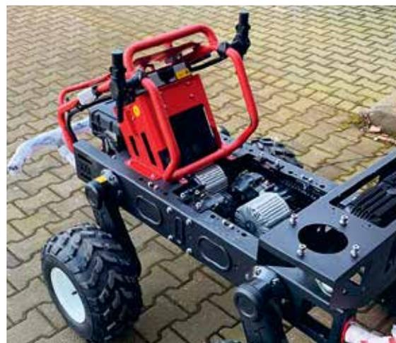
Abb. 6: Hier der autonom fahrende Sprühroboter der chinesischen Firma XAG Foto: Dr. Matthias Porten
