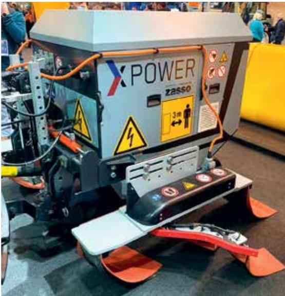
Abb. 3: In Thörnich stellen New Holland und Zasso den XPower XPS vor, der Kräuter im Unterstockbereich durch elektrischen Strom bekämpft.
