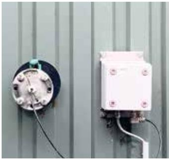
Das SensoStream-Baukastensystem ermöglicht erstmals eine Schwimmschichterkennung sowie eine exakte Messung der Substratgeschwindigkeit und -viskosität sowie des Behälterfüllstands in der Gesamtausbaustufe.
