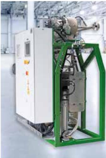
*Überschüssige thermische Energie aus industriellen Prozessen, aber auch aus Blockheizkraftwerken, lässt sich nur mit Abstrichen in Strom umwandeln. 2G hat in seinem ORC-System nun den Wirkungsgrad so erhöhen können, dass sich der Gesamtwirkungsgrad des Blockheizkraftwerks um bis zu 4 Prozent erhöht und Amortisationszeiten von bis zu zwei Jahren erreicht werden können.*
