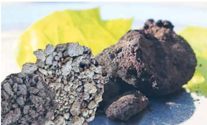
Mit Solution Green-Black werden Güllen und Gärreste in einem rein biologischen Verfahren in eine feste und eine flüssige Phase getrennt. Der feste Gärrest mit den Nährstoffen wird karbonisiert und dabei auf über 70 Prozent Trockensubstanz (TS) aufkonzentriert.
