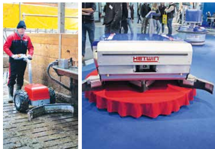
Mit dem akkubetriebenen Spaltenschieber Max (links) lassen sich Ausläufe und Spaltenböden leicht von Hand säubern. Der Mistsammelroboter Hetwin Avenger Pickup kann festeren und dünneren Mist getrennt voneinander einsammeln. Er hat eine Arbeitsbreite von 1,80 m.
