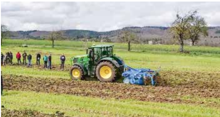
Bei der Kurzscheibenegge Rubin von Lemken war das klassische Rillenprofil zu erkennen. Positiv wurde der offeneporige Horizont beurteilt.
