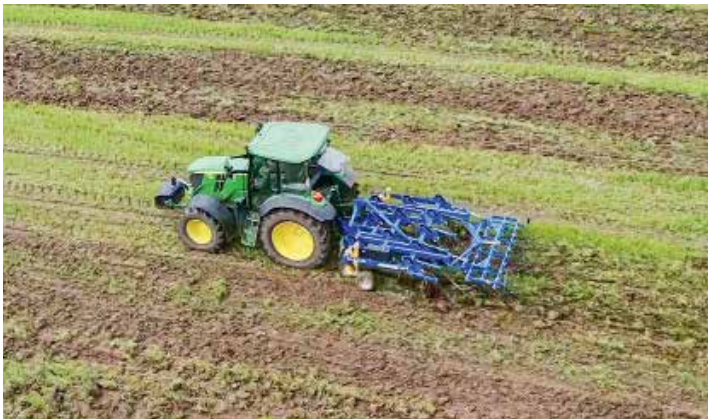
Der Flachgrubber TGA von Treffler konnte die Grasnarbe flach und ganzflächig schneiden und legte sie an der Oberfläche ab.
