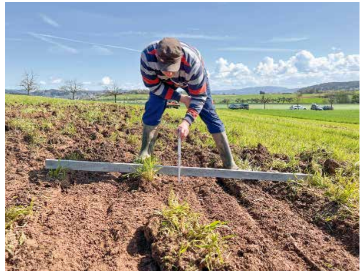
Auch der Grubber von Horsch konnte die Grasnarbe nahezu komplett vom Unterboden trennen, allerdings bei deutlich tieferer Arbeitsweise.
