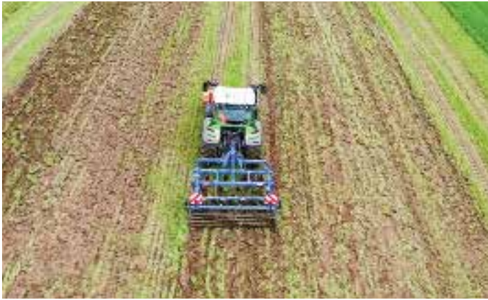
Der Agripol-Universalgrubber hatte die Grasnarbe nahezu vollständig flach, über die gesamte Arbeitsbreite geschnitten.
