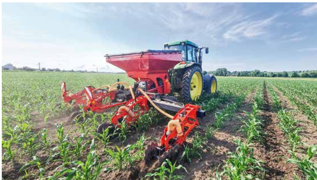
Für jede zweite Maisreihe wird ein spezielles Messersech mit vorauslaufender Schneidscheibe eingesetzt.
