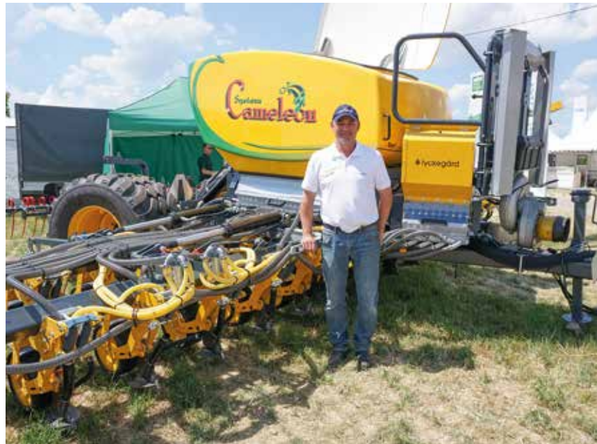
Kai-Uwe Horst von der Firma Lyckegård präsentierte mit der „Cameleon“ eine Maschine, die an unterschiedliche Anbausysteme angepasst werden kann und außerdem für mehrere verschiedene Arbeitsgänge eingesetzt wird: Säen, Unkrauteggen, Reihenhacken, Eggen, Düngen und verschiedene Kombinationsdurchgänge.
