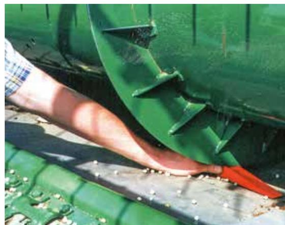
Die Querförderschnecke wird zirka 20 mm über der Mulde abgesenkt. Foto: Feiffer
