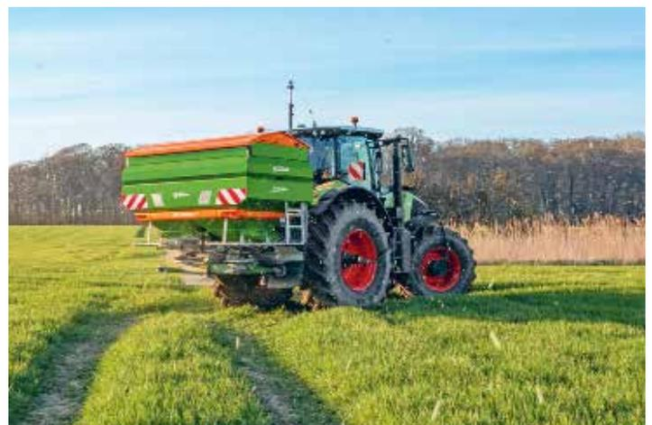
Mit dem System „CurveControl“ wird erstmalig das Streubild eines Zentrifugalstreuers bei einer Kurvenfahrt angepasst.
