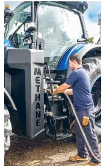
Mit der Implementierung der LNG-Technik in den T7.270 Methane Power lässt New Holland LNG-Gasmotorenkonzepte jetzt auch in der Landwirtschaft zu einer Antriebsoption werden.
