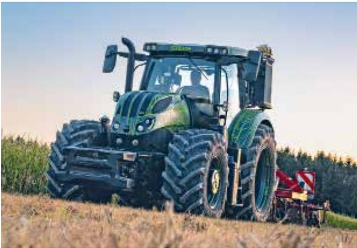
Mit dem diesel-elektrischen Antrieb seines Hybrid CVT-Traktors gelingt es Steyr, eine Reihe zusätzlicher Funktionen in die Traktorentechnik zu integrieren. Fotos: DLG
