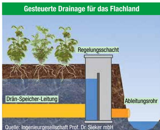
Durch gesteuerte Drainagen lassen sich die Drainageausläufe mittels Schieberelementen in einem Regulationsschacht aktiv in ihrem Durchlass regulieren, um eine temporäre Wasserspeicherung im Flachland zu erreichen.
