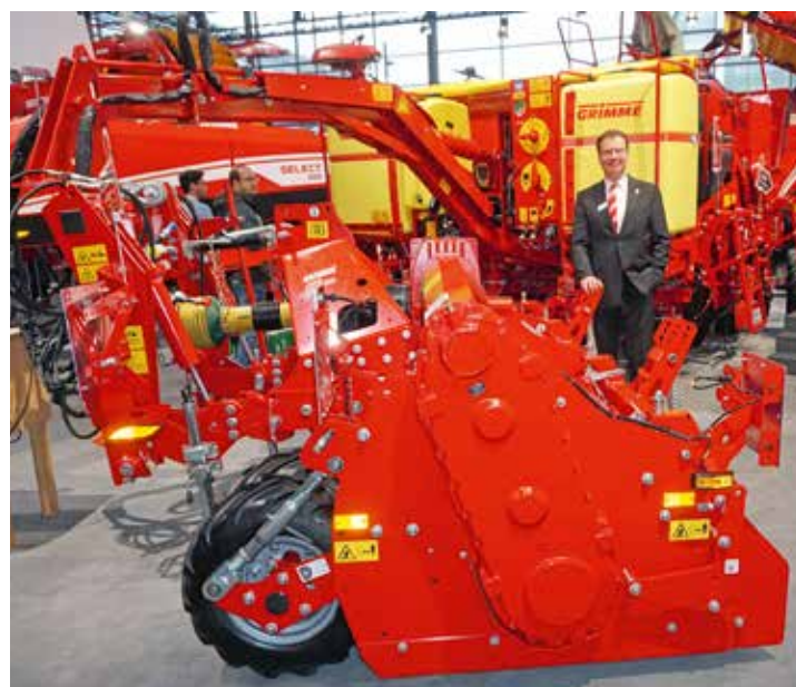
Jürgen Feld betonte am Stand von Grimme, dass die Prios 440 bei voller Ausstattung sieben Arbeitsschritte in einer Überfahrt erledigen kann.
