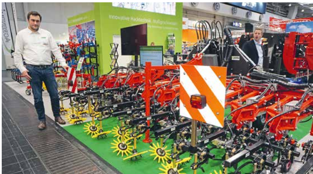
Felix von Klot mit der Rüben-Inrow-Hacke mit K.U.L.T.iScan-Technologie. Hierbei erkennt ein Sensor KI-gestützt die Rübenpflanzen und lässt die Inrow-Messer exakt um diese herum arbeiten.
