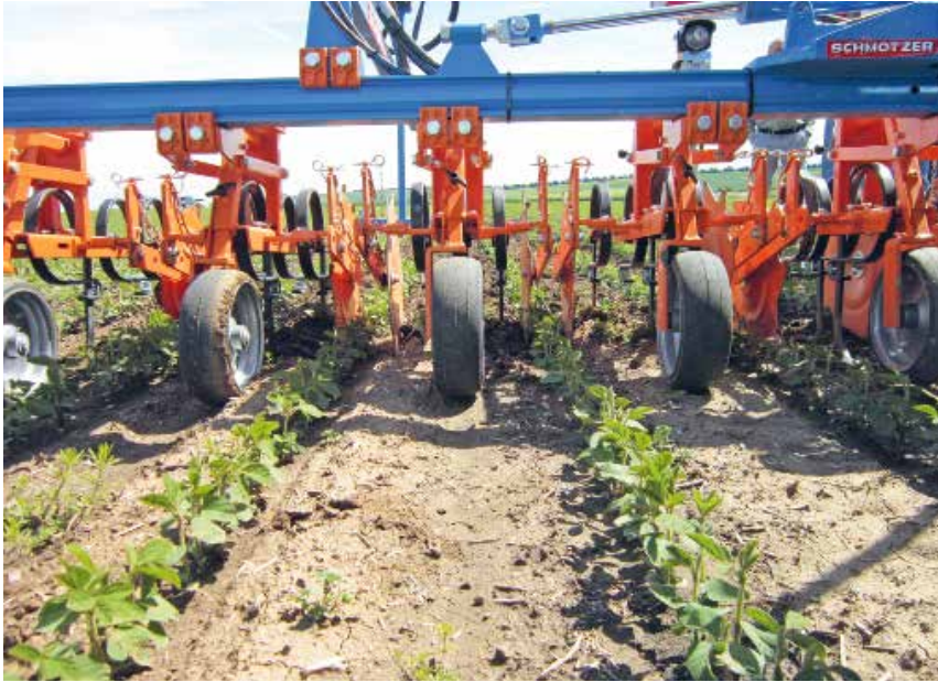
Die mechanische Beikrautregulierung ist, mit Ausnahme des Kartoffelbaus, im klassischen Ackerbau die einzige aktive Pflanzenschutzmaßnahme. Der optimale Einsatzzeitpunkt ist dabei genauso wichtig wie die richtige Einstellung der Technik und macht die Maßnahme zu einem Termingeschäft. Fotos: Cypzirsch
