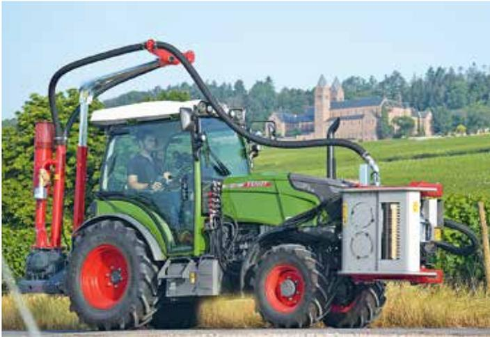
Der Entlauber Vitipulse Combi von der Ero GmbH ist eine Kombination aus Rollen- und Druckluftentlauber. Foto: Ero
