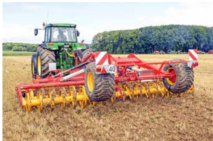
*Der Väderstad Carrier, ausgestattet mit Crosscutter disc, zeichnet sich durch eine offene Bauweise aus, in der sich keine Steine sammeln können. Die Scheiben ermöglichen einen ganzflächigen Schnitt von 5 bis 6 cm in den Boden.*
