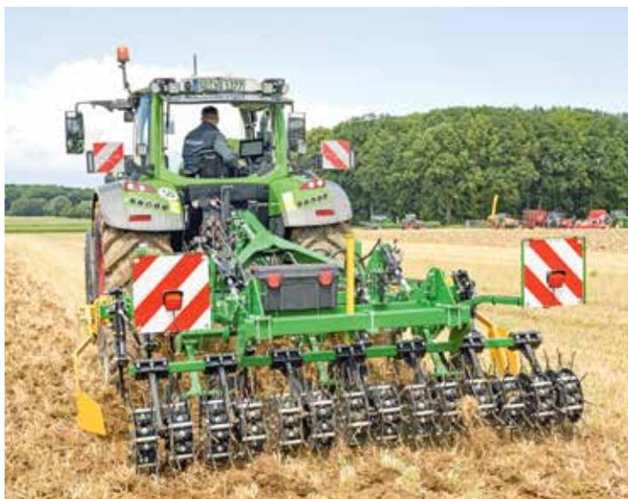
*Eine nachlaufende Striegel- bzw. Sternradwalze ist die Besonderheit des Kerner Corona 300. Die Striegel ziehen dabei die Vegetation nach oben raus und schleudern diese hoch, wobei sich weitere Erde löst. Das Gerät kann von ultraflach bis 30 cm arbeiten.*
