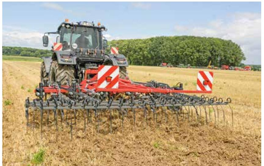
*Die ActiCut von 4Disc, auf den DLG-Feldtagen auch „fahrende Brotschneidemaschine“ genannt, ist für die sehr flache Bodenbearbeitung entwickelt worden. Die Schneidscheiben, die gegenläufig rotieren und 7 cm überlappen, werden über Rotoren aktiv angetrieben. Über einen Druckverstärker am Unterlenker lässt sich mehr Druck auf die Maschine bringen, gefolgt werden die Rotoren von einem großen Striegel zur Enterdung.*
