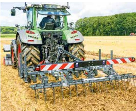
Beim Grindstar (TH Köln, Saphir) wird für die ultraflache Bodenbearbeitung der Boden durch je 7 Messer an 8 passiv angetriebenen Rotoren regelrecht abrasiert, der zweireihige Striegel enterdet die Organik.
