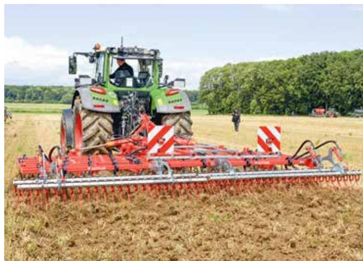
*Die Gütler Supermax Großfederzinkenegge arbeitet ultraflach, um das Material nicht zu durchmischen, sondern um Organik auf der Oberfläche abzutrennen und abzulegen. Die Striegel sind in der Neigung und damit in ihrer Aggressivität hydraulisch verstellbar.*
