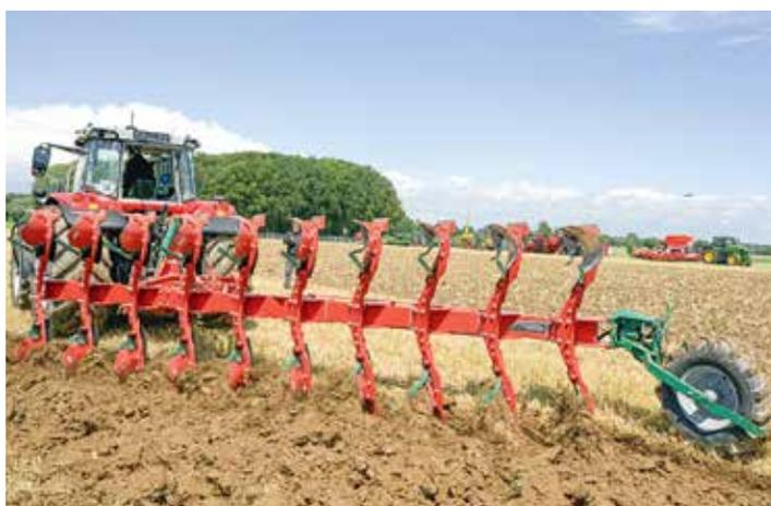
*Ultraflach arbeiten mit dem Pflug? Das geht mit dem Kverneland Ecomat Schälplug, der auf den Feldtagen mit 10 Scharen und 4 Meter Arbeitsbreite gezeigt wurde – und nur erstaunliche knappe 5 cm tief arbeitete. Er arbeitet flach wendend und verschüttet damit unerwünschte Samen. Die Schare sind eng angeordnet, weshalb die Streichbleche auch eine starke Wendelung aufweisen, um den Boden schnell zu drehen. Statt Vorschäler sind Stroheinlegebleche verbaut, um die Organik abzulegen.*
