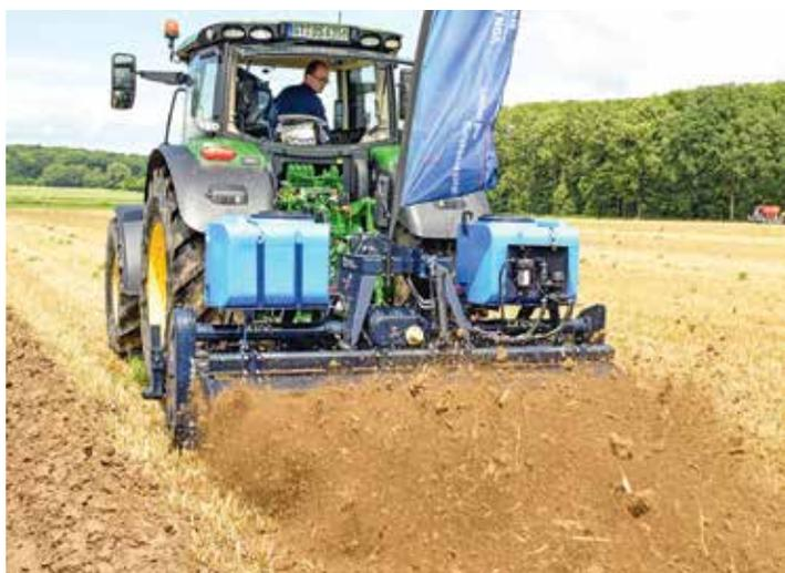
*Die Biofräse von Brevigliere wird über Reifen tiefengeführt, der Fräsenrotor arbeitet mit 400 Umdrehungen/Minute. Ziel der Biofräsen ist eine Flächenrotte der Organik zu ermöglichen. Dafür können in den angebauten Tanks auch Fermenterbakterien zur besseren Rotte eingesetzt werden.*
