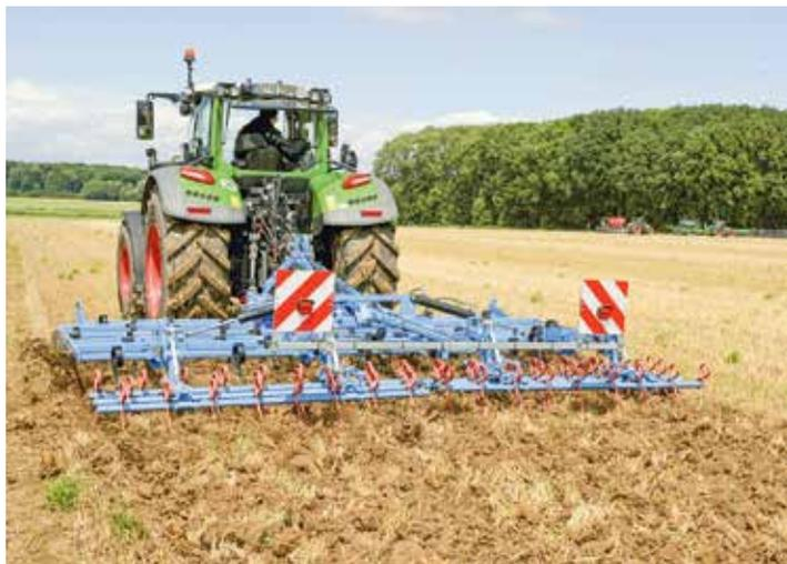
*Der Flachgrubber oder die Großfederzinkenegge von Bremer zeichnet sich durch den Einsatz von hartmetallbeschichteten Gänsefußscharen und den 6-reihigen Aufbau aus, hier gefolgt von einem dreireihigen Striegelfeld. Der recht hohe Rahmen von 51 cm ermöglicht einen guten Materialdurchfluss.*
