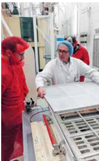
Martin Diehl zeigt Siebe des Plansichters. Bis zu 15 Siebe können untereinander angeordnet sein.
