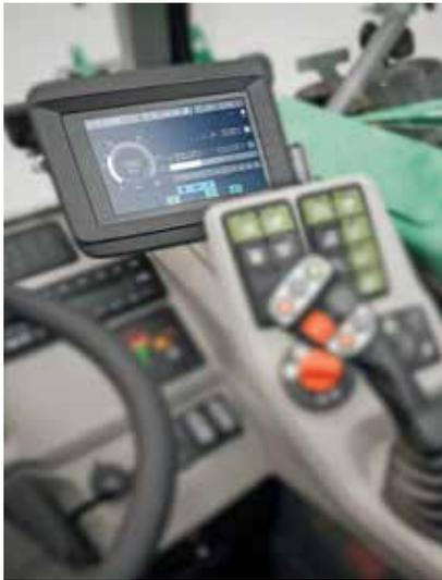
Das dynamische Wiegesystem von Kramer kann unabhängig vom Anbaugerät, dem Schwerpunkt der Last oder der Position der Ladeanlage inklusive der Teleskopfunktion arbeiten. Fotos: DLG
