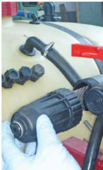
*Alle Bauteile der Pflanzenschutzspritze sind auf einwandfreie Funktion und Dichtheit zu überprüfen.*
