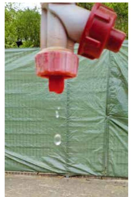
Düsen sind zu reinigen und das Spritzbild muss überprüft werden; sie dürfen nicht nachtropfen. Foto: Feger
