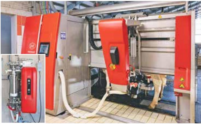
Der Astronaut A5 Next-Melkroboter von Lely verfügt über eine neue Melkarmsteuerung. Zudem gibt es einen Milchfilter (kleines Bild links unten) der nicht mehr ausgewechselt werden muss, da er über eine automatische Selbstreinigung verfügt. Werkfotos
