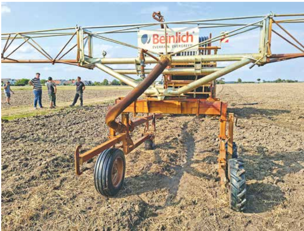
Düsenwagen R 30 von der Firma Beinlich mit 4-Rad-Fahrspurstativ und 30 m konstruktiver Breite und Drehkranz, passend zu Fahrgassenabständen von 15 m bis 27 m. Foto: Stefan Nauheimer, LLH
