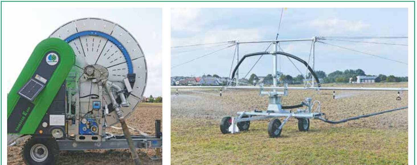
Die Firma Röhren- und Pumpenwerk Bauer GmbH zeigte ihr Auslegerstativ AS50 (rechtes Bild) an einer Trommelregenmaschine Rainstar E400, 100-590. Die konstruktive Breite des Gestänges beträgt 50 m. Mit entsprechenden Enddüsen an beiden Enden des Auslegers kann eine Streifenbreite von bis zu 90 m realisiert werden. Fotos: Jonas Schulze, LLH
