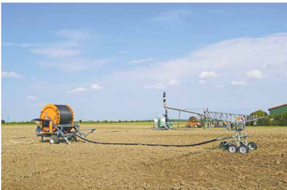
Die Firma Hüdig präsentierte die Trommelregenmaschine Iromat II RED PE-Rohr Ø 110 mm x 400 m mit dem Düsenwagen DW 18 mit 5-Rad-Fahrgestell und integrierter Tandem-Schwingachse für besonders hohe Beanspruchungen. Foto: Jonas Schulze, LLH
