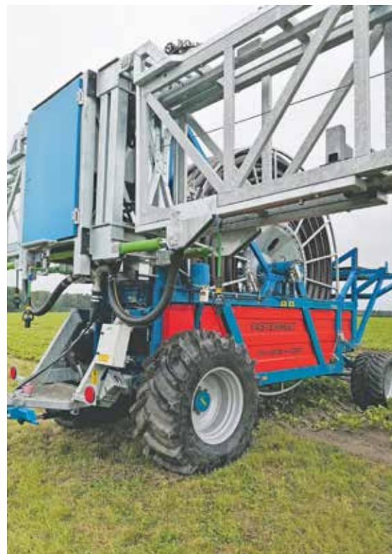
Selbstfahrende Regenmaschine von Beregnung Fasterholt GmbH mit teleskopier- und hydraulisch klappbarem Düsengestänge.
