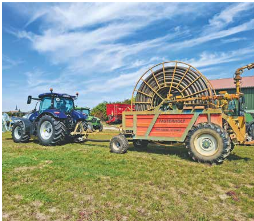
Maschine FM 4800 HYDRO, Beregnung Fasterholt GmbH, in Transportstellung. Die Maschine wird über den mitgelieferten A-Rahmen angekoppelt.
