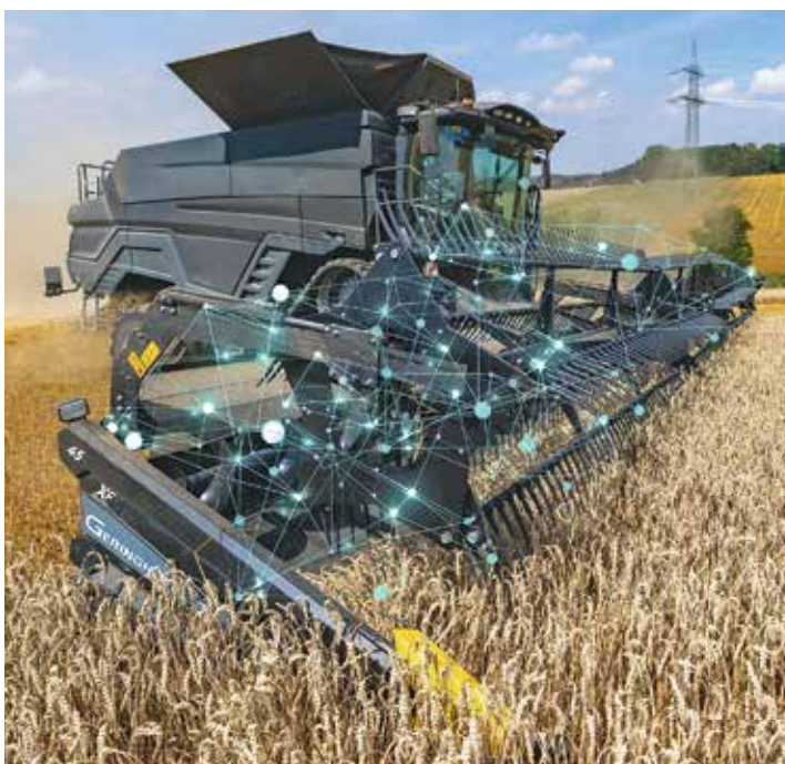
Der Mähdrescherfahrer erhält mit YieldEyeQ erstmalig bereits während des Erntevorganges eine Entscheidungsunterstützung zur Wirkung von Einstelloptimierungen am Erntevorsatz.
