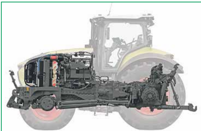
Durch das Zusammenspiel aller Teilfunktionen stellt das vorausschauende, adaptive Antriebstrang-Managementsystem für stufenlose Traktorgetriebe von Claas eine innovative Weiterentwicklung der bekannten Konzepte dar.
