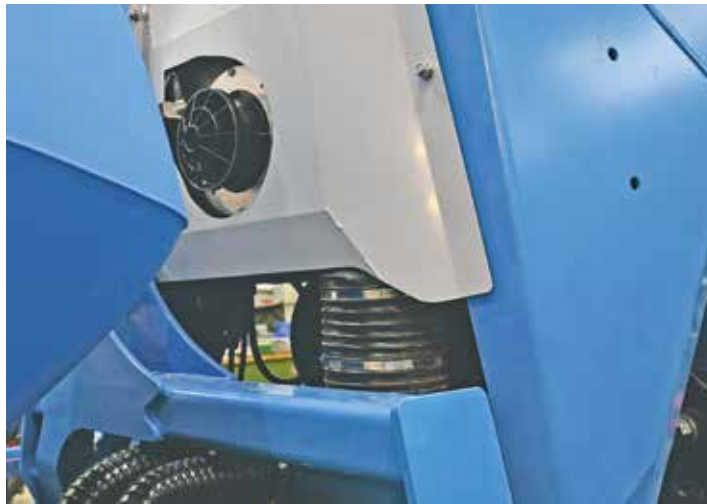
Mit der iQblue Fan Automation entwickelt Lemken die pneumatische Sätechnik in einem entscheidenden Schritt weiter.
