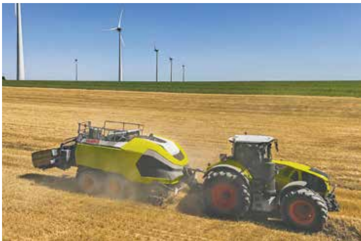
Das von Claas komplett neu entwickelte Maschinenkonzept einer 70-t-Quaderballenpresse ist auf die Kombination hoher Durchsätze mit konstant hohen Ballendichten und sicherer Bindung ausgelegt und erschließt neue Leistungsdimensionen für diesen Maschinentyp. Fotos: dlj
