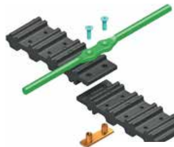
Das neu entwickelte Riconda-Siebbandkonzept von Grimme führt zu deutlich geringerem Verschleiß und erleichtert den Austausch beschädigter Siebbandbereiche.
