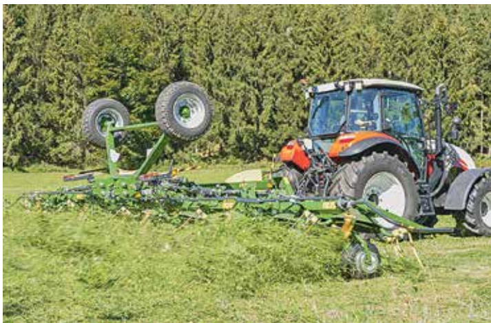
Mit dem OptiSet von Krone kann der Anwender über eine Funkfernsteuerung aus der Kabine den Streuwinkel aller Kreisel zentral und synchron per Tastendruck stufenlos zwischen 13 und 19 Grad einstellen.
