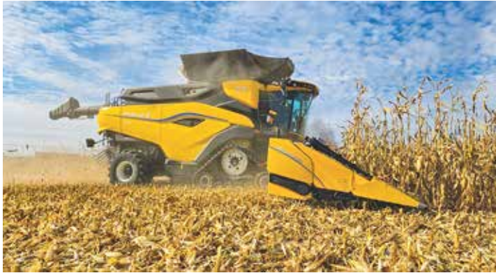
Der vollautomatisierte Maispflücker mit „Corn Header Automation“ von New Holland kann die Aufnahmeverluste um bis zu 50 Prozent reduzieren.
