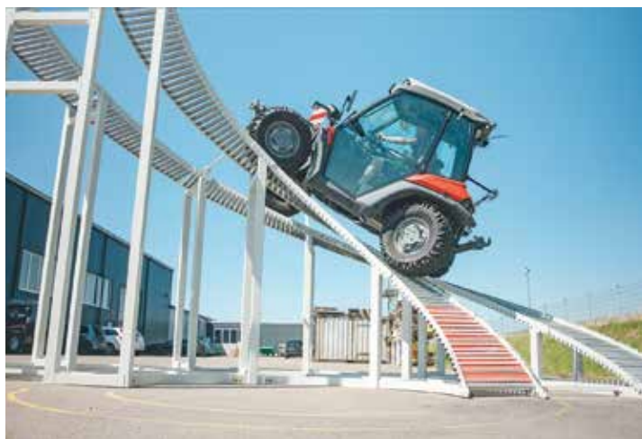
Das Line-Traction-Antriebssystem verbessert nicht nur die Traktion und vermindert Schäden an der Grasnarbe, sondern erhöht auch die Sicherheit bei Wendemanövern in Hanglagen.
