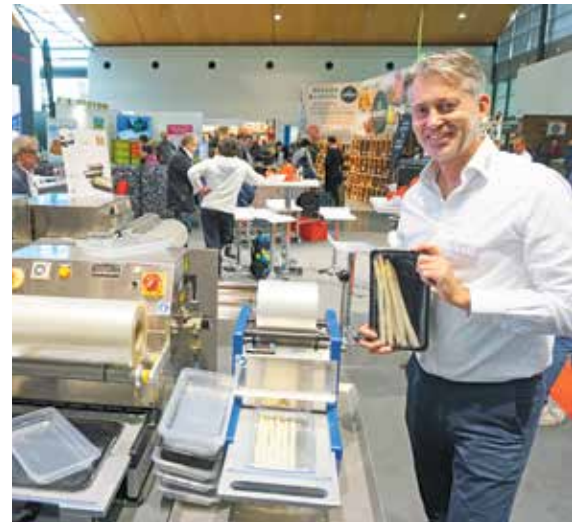
An Schalsiegelgeräten mit Schnellwerkzeug zum Versiegeln von Gemüse und Obst in verschiedenen Verpackungseinheiten informierte Christoph Wolter, Geschäftsführer der HEPRO GmbH: „Im nächsten Jahr bringen wir eine patentierte Siegelschale mit integrierter Dampfgarerfolie heraus. Damit kann beispielsweise Spargel in der Mikrowelle in Kürze gegart werden.“
