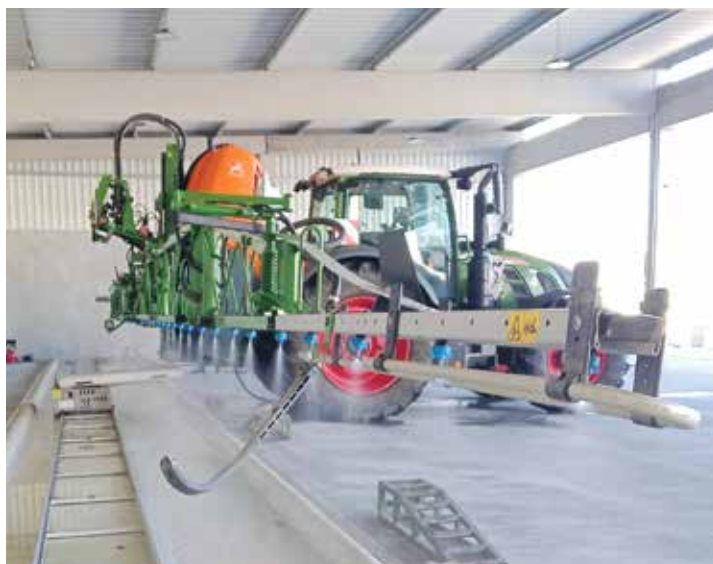
Spritze auf dem Prüfstand während der Querverteilungsmessung der Düsen. Foto: Feger
