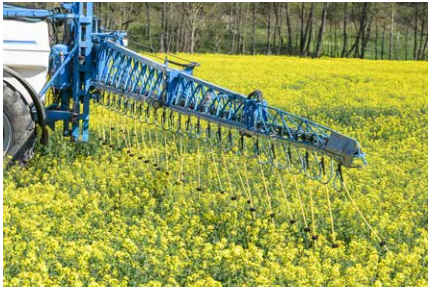
Eine Blütenbehandlung mit Dropleg-Düsen bringt den Wirkstoff gezielt in den unteren Bereich des Bestandes und verbessert die Bienenverträglichkeit deutlich.
