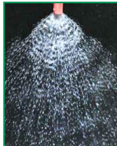
Lange Injektordüsen zeichnen sich bei Drücken von 3 bar durch eine grobe Tropfenstruktur aus. Zur Bestandesdurchdringung und Abdriftminderung sind sie ideal.
