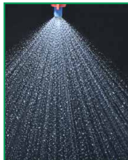
Kompakte Injektordüsen haben schon bei 3 bar einen ausreichend großen Feintropfenanteil und sind dadurch für ein weites Einsatzspektrum geeignet.
