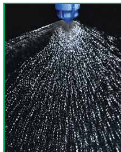
Luftansaugende asymmetrische Doppelflachstrahldüse eignen sich zur Benetzung kleiner Zielflächen, die sich eventuell zusätzlich dicht an Kulturpflanzen befinden – Spritzschatten werden reduziert.
