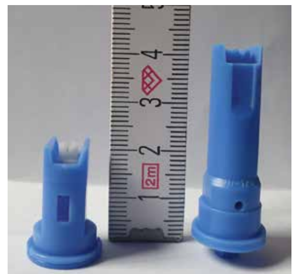
Links: kurze IDK-Düse; optimaler Spritzdruck 2 bar aufwärts; rechts: lange ID-Düse, optimaler Spritzdruck 4 bar aufwärts. Fotos: Wald
