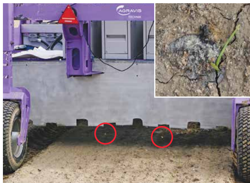
Bei genauem Hinsehen kann man unter dem Weeder die Laser-Spots aufblitzen sehen. Oben rechts eine dadurch versengte Ungraspflanze.
