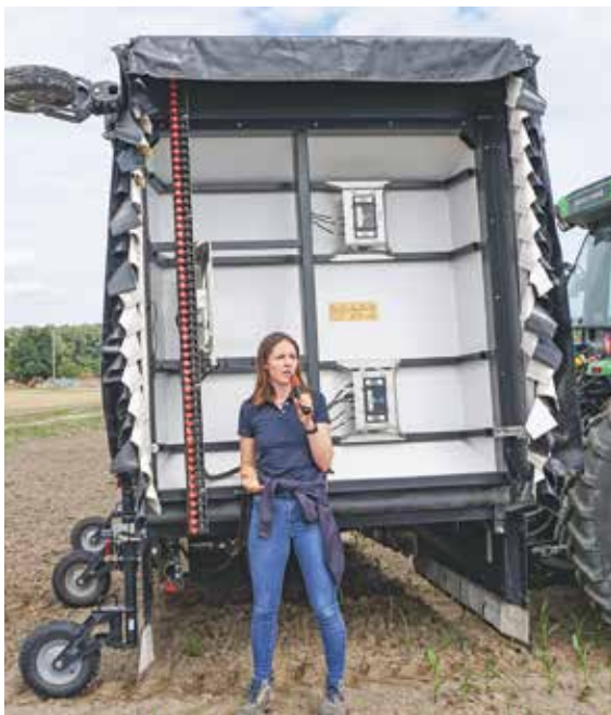
Die ARA-Feldspritze von Ecorobotix arbeitet mit 156 hochpräzisen Spritzdüsen in einem Abstand von 4 cm.
