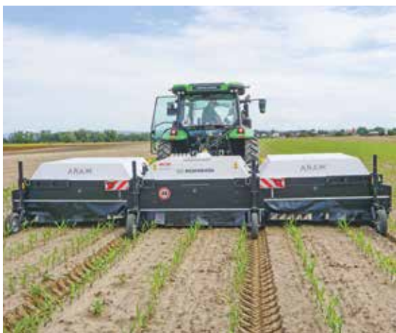
Die ARA-Feldspritze arbeitet abgeschildert mit eigenem Licht, was die Pflanzenerkennung und -behandlung unabhängig von äußeren Einflüssen macht.
