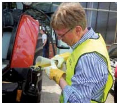
Der Verbrauch bei schweren Zapfwellenarbeiten wurde im Stand und bei leichteren Arbeiten im Fahrbetrieb gemessen.
