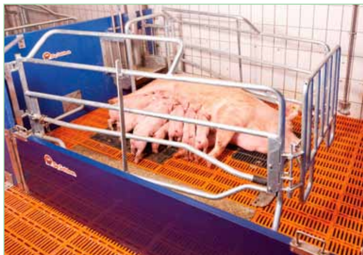
Von mehreren Herstellern angeboten werden Freilauf-Abferkelbuchten mit Ferkelschutzkorb. Bei der Kombi-Abferkelbucht vom dänischen Hersteller Ikadan ist der Ferkelschutzkorb diagonal ausgerichtet und findet in jeder herkömmlichen Abferkelbucht Platz (linkes Bild). Die Freilaufbucht von Big Dutchman (rechtes Bild) kann mit wenigen Handgriffen eng oder weit gestellt werden.
