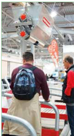
Die Automatisierung von Arbeitsabläufen spart Zeit. So auch der Spaltenreinigungsroboter von JOZ Tech (links), der trockene Spalten vor dem Reinigen mit Wasser einsprüht, ein schienengeführtes Einstreugerät für Liegeboxen von Hartmann (mittleres Bild), das nur in Boxen einstreut, in denen keine Kuh steht und ein Grundfutter-Vorlagegerät von Kuhn. Fotos: Brammert-Schröder, Werkfotos
