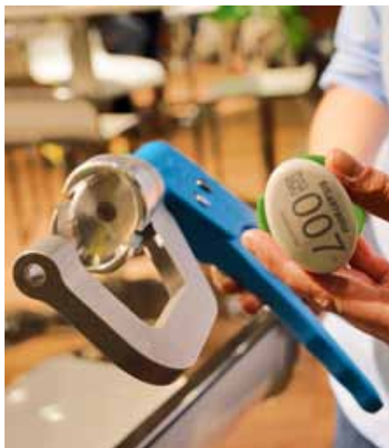
Eine immer größere Rolle spielt die automatisierte Gesundheitsüberwachung von Kühen. Eine Ohrmarke, um Kühe zu orten, Brunsten zu erkennen und das Wiederkäuen zu überwachen, bietet die Firma Smartbow (links). Das Moo Monitor-Halsband von Dairymaster erkennt Brunsten und erfasst die Wiederkauaktivität sowie Fress- und Ruheverhalten.
