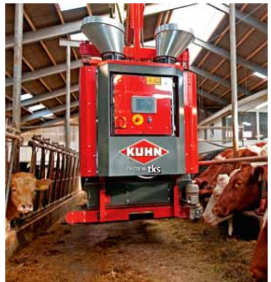
Die Automatisierung von Arbeitsabläufen spart Zeit. So auch der Spaltenreinigungsroboter von JOZ Tech (links), der trockene Spalten vor dem Reinigen mit Wasser einsprüht, ein schienengeführtes Einstreugerät für Liegeboxen von Hartmann (mittleres Bild), das nur in Boxen einstreut, in denen keine Kuh steht und ein Grundfutter-Vorlagegerät von Kuhn. Fotos: Brammert-Schröder, Werkfotos
