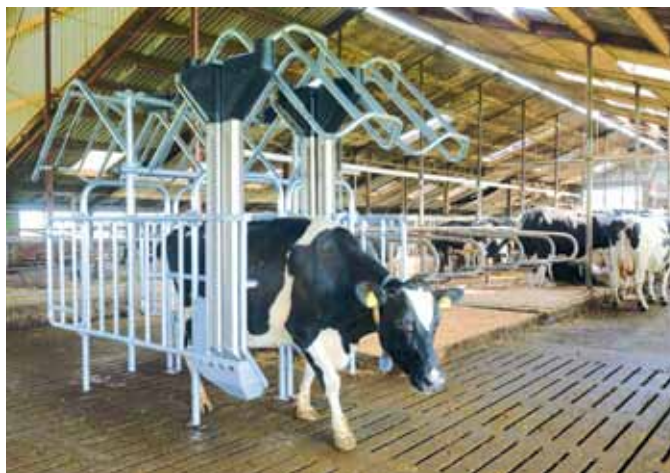
Immer häufiger angeboten werden flexible Boxenabtrennungen für den Milchviehstall (im Bild links das System von Deltex). Bei der Durchlauf-Kraftfutterstation von Hanskamp (rechts) können die Kühe ganz komfortabel die Station auch nach vorne verlassen.
