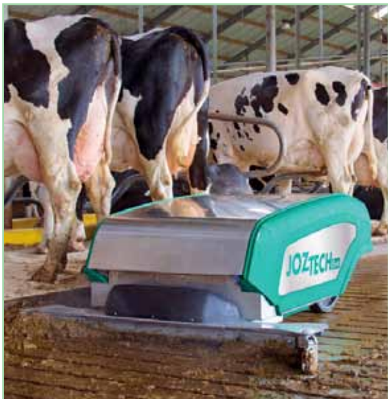
Die Automatisierung von Arbeitsabläufen spart Zeit. So auch der Spaltenreinigungsroboter von JOZ Tech (links), der trockene Spalten vor dem Reinigen mit Wasser einsprüht, ein schienengeführtes Einstreugerät für Liegeboxen von Hartmann (mittleres Bild), das nur in Boxen einstreut, in denen keine Kuh steht und ein Grundfutter-Vorlagegerät von Kuhn. Fotos: Brammert-Schröder, Werkfotos
